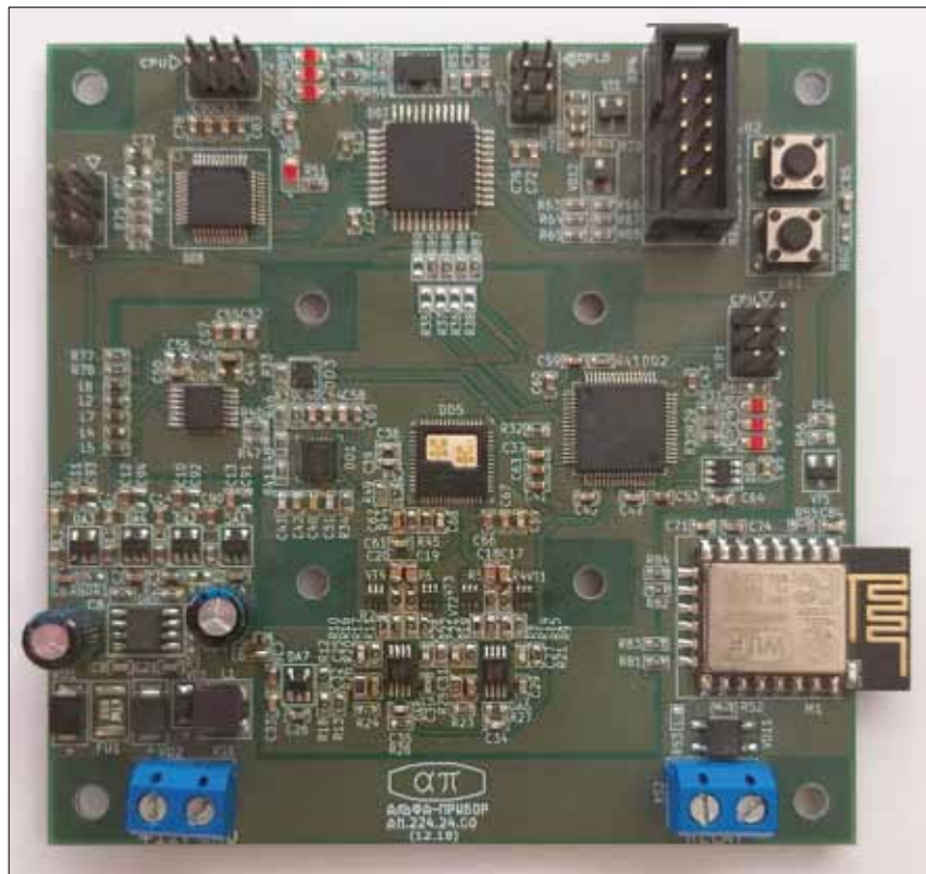
▲ Рис. 3. Печатная плата радара
