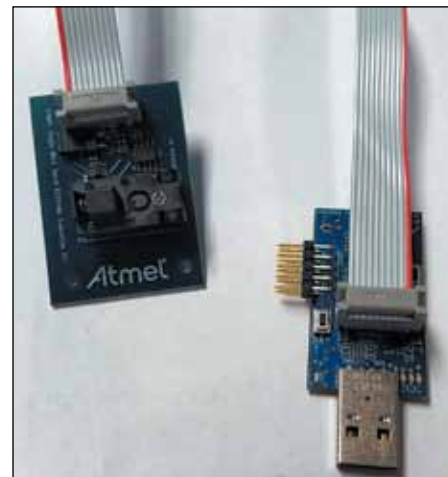
Рис. 3. Платы оценочного набора AT21CSMK100 с плоским шлейфом
