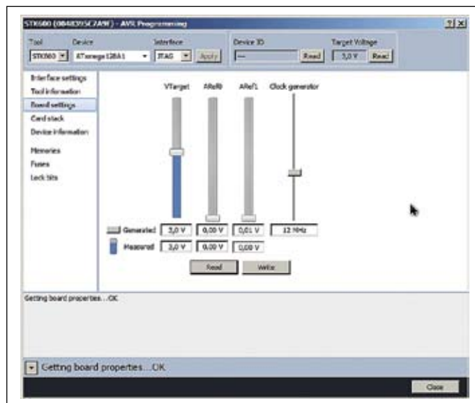
Рис. 2. Стандартное диалоговое окно программирования микроконтроллера
