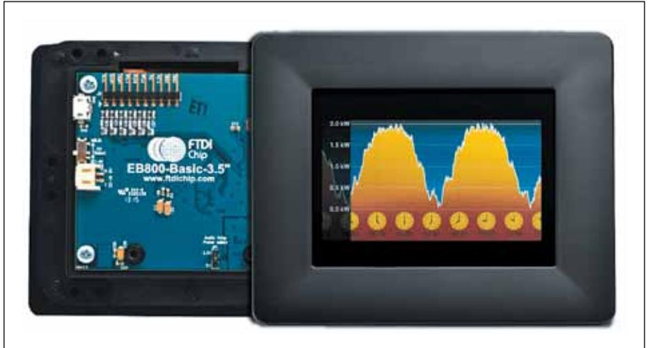
Рис. 4. Отладочный модуль VM800Vxx-xx
