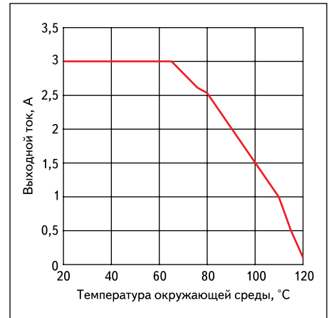
Рис. 7. Зависимость максимального выходного тока модуля питания LMZ14203 от температуры окружающей среды
