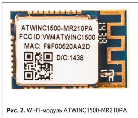
Рис. 2. Wi-Fi-модуль ATWINC1500-MR210PA
