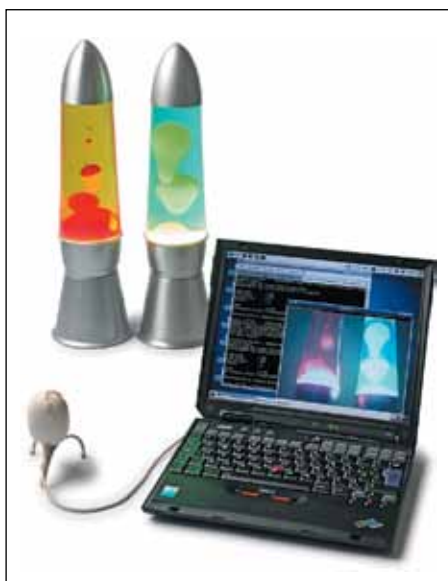
Рис. 12. Генератор случайных чисел Lavarand
