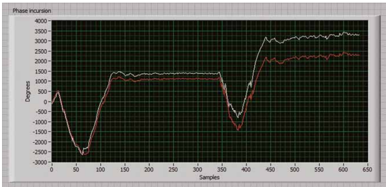
▲ Рис. 7. Набег фазы при двух дыхательных циклах при отражении от области живота
