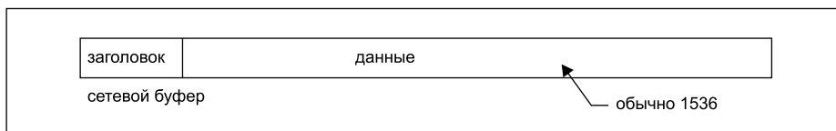
Рис. 1. Схематическое изображение размещения кадра Ethernet в буфере
