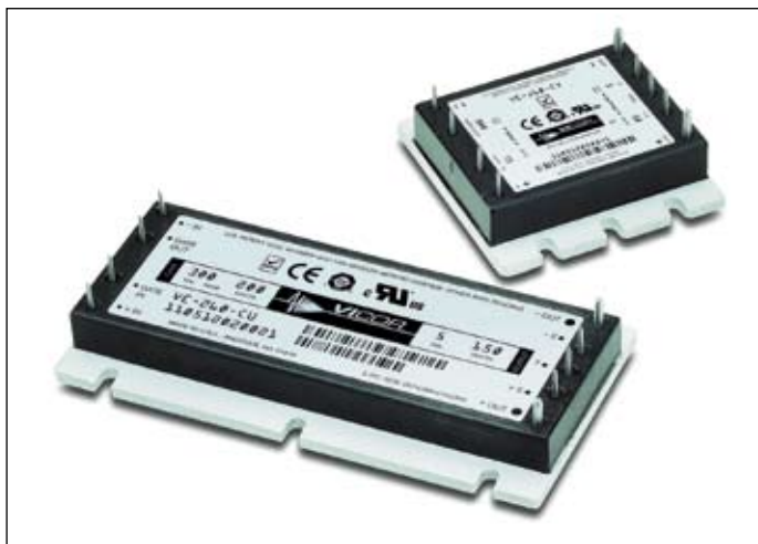
Рис. 1. DC/DC-конверторы первого поколения: «кирпич» и «полкирпича»
